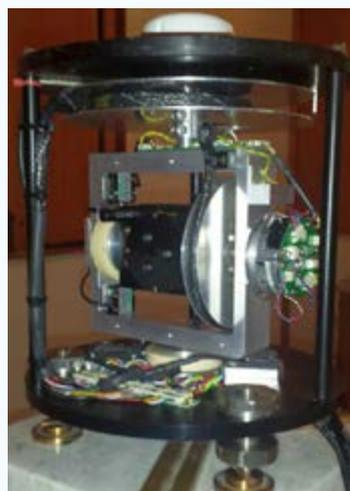
Figure 1 : Le GYRODIF qui a été installé en Antarctique. L'appareil mesure automatiquement : la direction du Nord géographique, la direction du Nord magnétique et l'inclinaison magnétique
