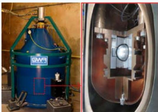
Figure 2: Le gravimètre à supraconductivité de Membach et un éclaté du capteur avec la sphère en lévitation.
